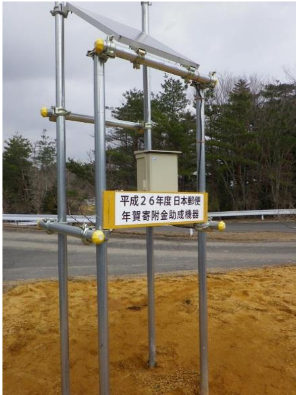
写真3 太陽光発電利用線量計1
