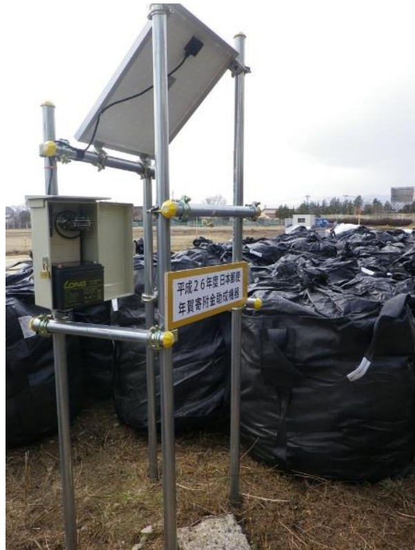
写真4 太陽光発電利用線量計2
